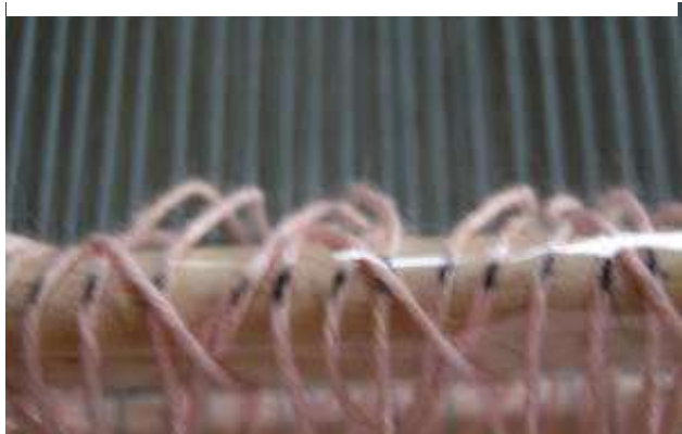
全て巻き終わったら、糸の印の上に、テープを貼る
