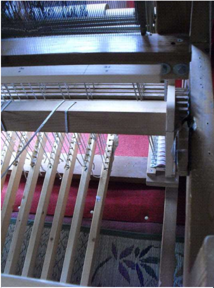
織り上がった布を巻く機能は、自転車のギアを使っています。
