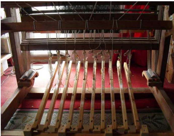
綜統枠と踏み木の間に招木(ラム)を使っています。ラムを使うことで、綜統枠のスムーズな操作を可能にしています。
