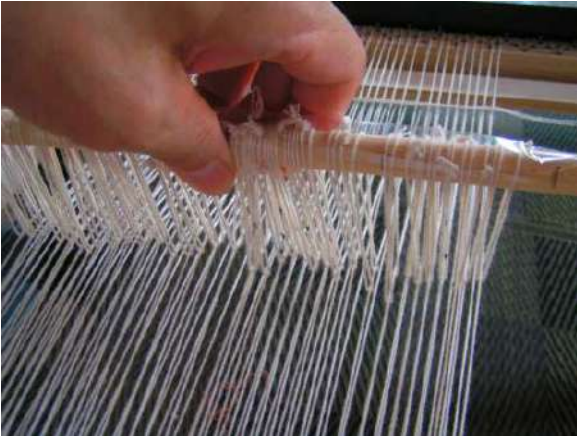
開講へ打ち込みスティックを入れ、スティックを立てて開口を確保する。
